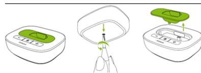
Insérez entièrement l'autre socle. Appuyez et serrez doucement la vis.
