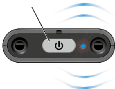
2. **Placez le SoundGate Mic en mode d'appairage** en appuyant sur son bouton Marche/Arrêt pendant environ 5 à 6 secondes. Le voyant DEL du SoundGate Mic prend alors la couleur orange et clignote rapidement. Le " Mode appairage " est maintenant activé.
