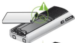
2. Insérez d'abord le côté des contacts.
