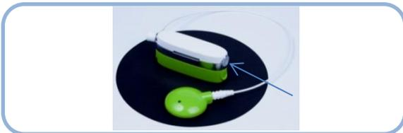
Pour mettre le dispositif sous tension, appuyez et maintenez le bouton Marche/Arrêt enfoncé pendant 1-2 secondes. Le voyant lumineux intégré au bouton doit clignoter **orange** pour indiquer l'état de charge de la pile (ex: 4 clignotements correspondent à une pile complètement chargée). Ce bouton indique ensuite par des clignotements **vert** la position de programme utilisée.
