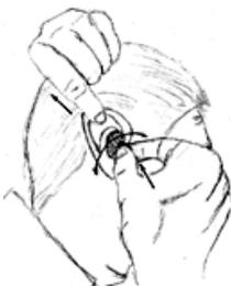
Clipser les filtres sur les embouts en s'assurant de leur bon positionnement.
