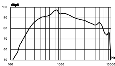
Niveau de sortie (OFL) à 50 dB SPL en entrée à un gain maximum*
